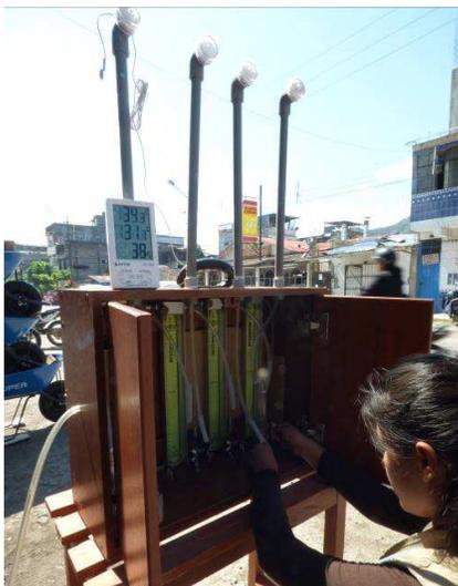
**Figura 3.** Instalación del tren de muestreo de calidad de aire.
