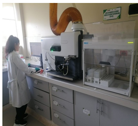
Figura 7. Lecturas de la concentración de Cd en tejidos vegetales por espectrofotómetro de emisión atómica de plasma por microondas (MP- AES)
