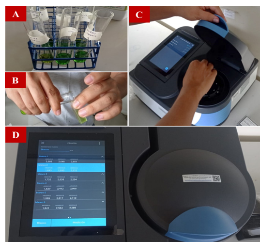
Figura 7. Lecturas de la concentración de Cd en tejidos vegetales por espectrofotómetro de emisión atómica de plasma por microondas (MP- AES)
